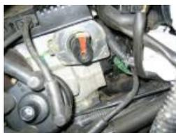
der Verteilerfinger steht dann zwischen dem ersten und dem zweiten Zylinder ( siehe Beschriftung Verteilerkappe )
